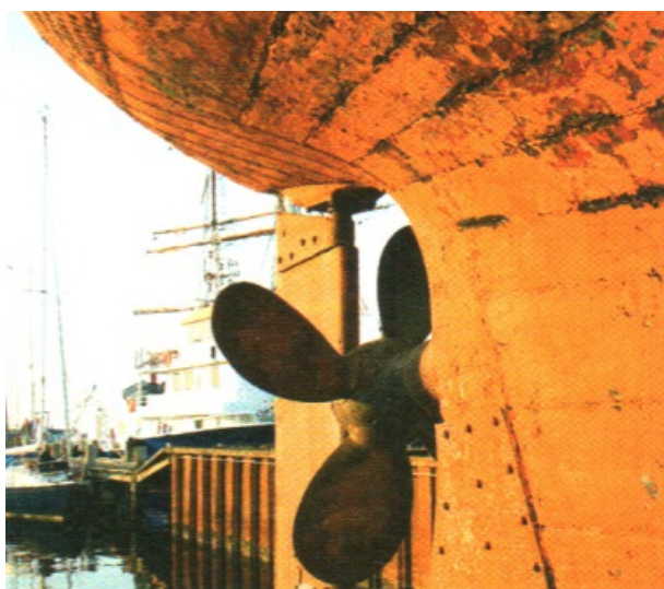
Coque d'un bateau corrodée
