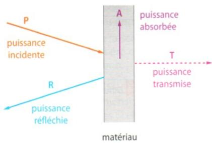
L'aptitude d'un matériau à absorber est évaluée à partir du coefficient d'absorption alpha de Sabine ( $\alpha$ ) par fréquence sur une échelle de 0 à 1 :
